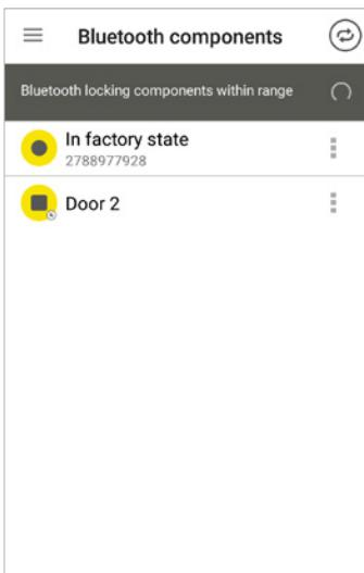
(DE) Öffnen Sie die AirKey-App. Smartphone muss eine Wartungsberechtigung für die Schließanlage haben. Wecken Sie den Zylinder im Auslieferungszustand durch händische Berührung auf, um in der Liste der Bluetooth-Schließkomponenten in Reichweite gelistet zu werden.
