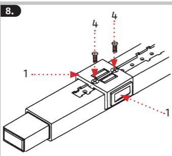
Rote Griffplatten oben und unten eindrücken und Riegel ausschieben. Bei Türblattbreiten über 860 mm muss der Riegel auf der Scharnierseite der Tür um 1 bis 9 Teileinstellungen verstellt werden (1 Teilung = 19 mm). Je nach Position des schlossseitigen Schließkastens oder bei engem Nischenbereich den kurzen Riegel um 1 Teilung vor- oder zurückstellen. Riegelverstellung: Riegelgehäuse abnehmen. Rote Griffplatten des Schiebers ganz eindrücken und festhalten (Abb. 7).
