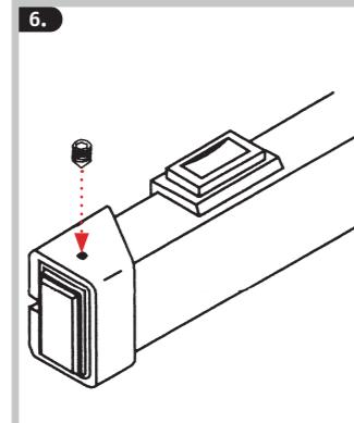
Riegelgehäuse wieder in beide Befestigungsbügel einlegen. Der sichtbare Riegel zeigt zur Scharnierseite hin. Mit einer Madenschraube von oben leicht festklemmen (Abb. 6).
