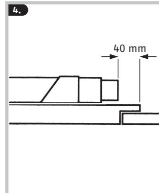
Riegelgehäuse einlegen. Die ganz eingeschobene Riegelseite zeigt zur Türschlossseite hin. Waagerecht ausrichten, hinteren Befestigungsbügel anhalten und Bohrlöcher anzeichnen. Abstand des eingeschobenen Riegels zur Scharnierseitentürkante mind. 40 mm (Abb. 4).
